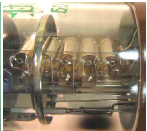
Imágenes del Tubo fotomultiplicador RCA C31034A-02 y a la derecha detalle de los dínodos .
